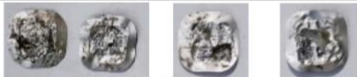
周囲のアルミ部分が激しく噛まれている 中の部分が激しく潰されている L字型の穴がある (岐阜県提供)
